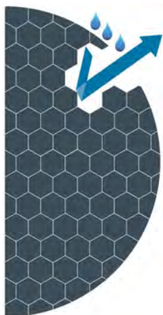
"(c) Kaimann GmbH Díky struktuře uzavřených buněk nepřestane izolace plnit svou funkci i při jejím poškození."
