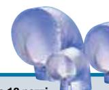
Curve in alluminio gofrato, costituite da due semicurve stampate e saldate ad ultrasuoni sul sormonto della nervatura esterna - Ordine minimo Set da 10 pezzi
