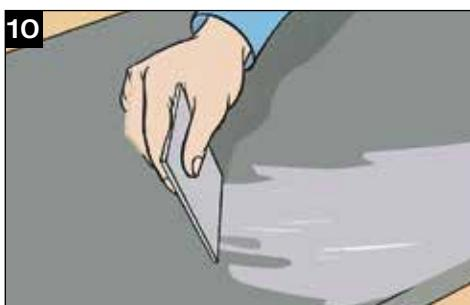
Voor het verdelen van de lijm op grote oppervlakken kan men een spatel gebruiken. Ook hier moet de lijm spaarzaam aangebracht worden. Na voldoende droogtijd kan het plaatmateriaal op het te isoleren vlak worden aangebracht.
