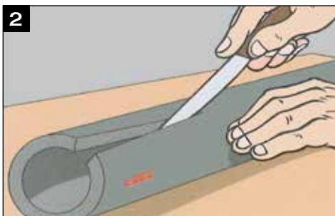
➊ Om het verlijmen vervolgens te vereenvoudigen, is het raadzaam alleen zeer scherpe mesjes te gebruiken.
