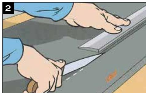
Een kort stuk beschermfolie wordt van de plaat getrokken.
