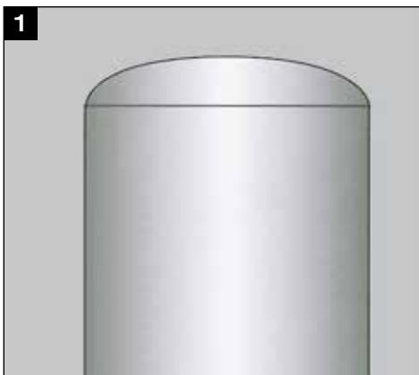
Om de omtrek van het reservoir te bepalen neemt men een Kaiflex strip die even dik is als het toe te passen Kaiflex isolatiemateriaal.
