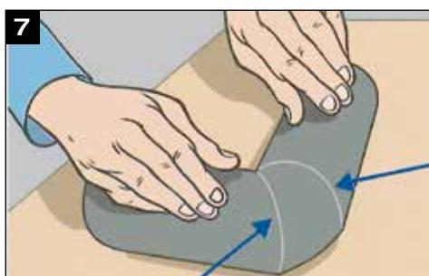
Na het drogen van de lijm kan de hoek, aan de binnenkant, in de lengterichting worden doorgesneden.
