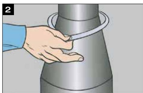
Nu brengt men de maten (de grootste en de kleinste diameter en de hoogte) op de Kaiflex plaat over. Vervolgens tekent men twee lijnen van de buitenste punten tot aan het snijpunt met de middellijn.
