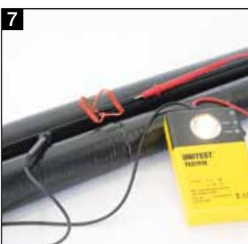
*Durchgangsprüfung der Fühlerleitung.*
