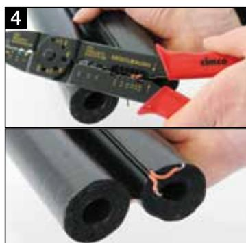
*Fühlerleitung abisolieren, 1cm*
